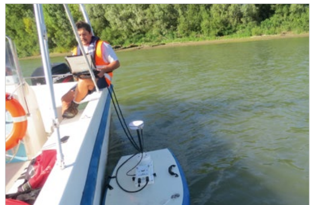
Misura di portata liquida durante la campagna di misura di risalita del cuneo salino nel delta del Po.
