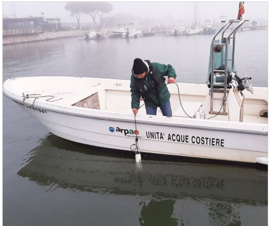
FIG. 2 MISURAZIONE Attività di misura dei parametri chimico-fisici sui rami del delta tramite sonda multiparametrica.
