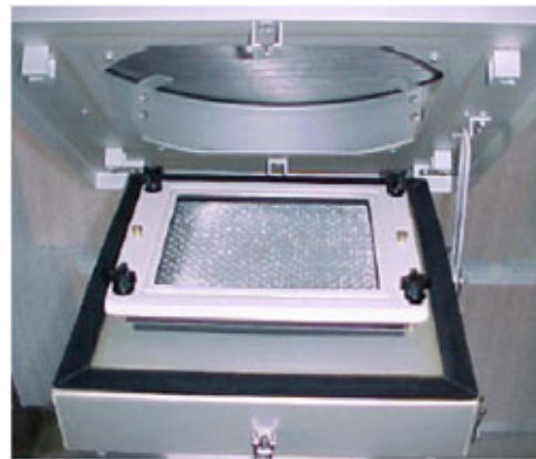
Foto 2.4 Alloggiamento del portafiltro [Tisch Environmental, Inc. 1999]
