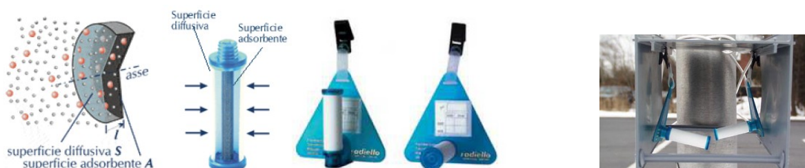
Figura: Campionamento radiale diffusivo (passivo): particolare dei radielli utilizzati per i campionamenti
