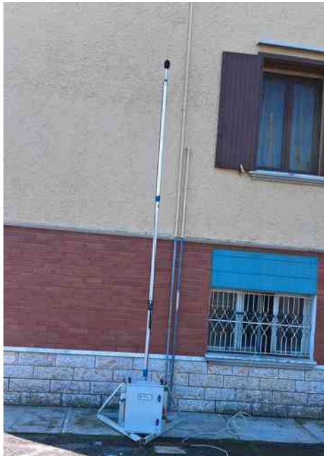
Foto 2: Fonometro e palo con microfono a 4 metri
