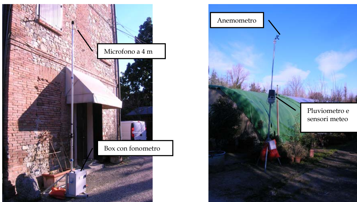
Figura 2 – Strumentazione per il monitoraggio acustico e stazione meteorologica
