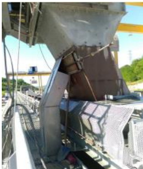
Fig. 8 – Tramoggia con campionatore a deviazione di flusso
