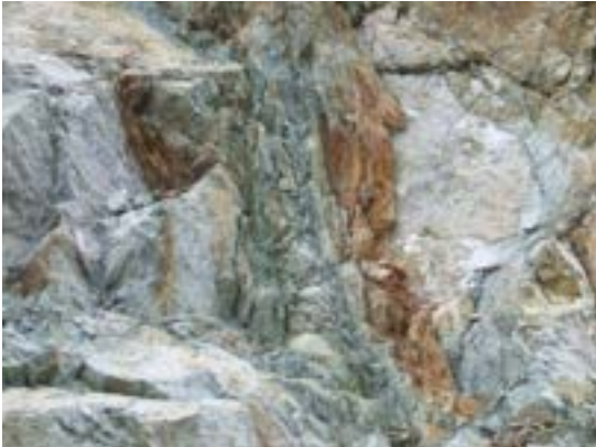
Figura 16 - Esempi di litotipi potenzialmente amiantiferi: Metagabbri in Facies scisti blu dell'Unità Voltri. Frequentemente le masse di metagabbri sono intruse da filoni basaltici e spesso attraversate da faglie che favoriscono la cristallizzazione di associazioni mineralogiche ad anfibolo fibroso della serie attinolute-tremolite
