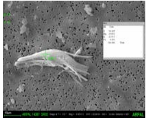
Figura 18 - Analisi microscopica: Analisi allo stereomicroscopio: fasci submillimetrici di crisotilo
