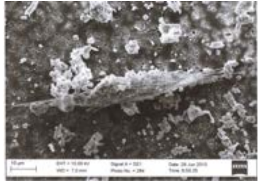
Figura 6 - "Agglomerato" di fibre di fluoro-edenite riscontrato in un campione di particolato atmosferico prelevato a Biancavilla nel 2010
