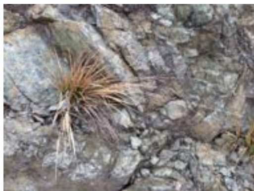
Figura 14 - Esempi di litotipi potenzialmente amiantiferi: Serpentiniti - Unità Voltri (Genova, Loc. Piani di Praglia): potenziale presenza di crisotilo in massa in funzione del grado metamorfico
