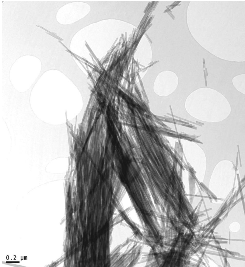
Immagine al microscopio elettronico a trasmissione (TEM) di un fascio di crisotilo proveniente dalla cava di Dossi di Franciacorta (Valmalenco, Sondrio): si distinguono le fibrille che compongono il fascio di amianto
