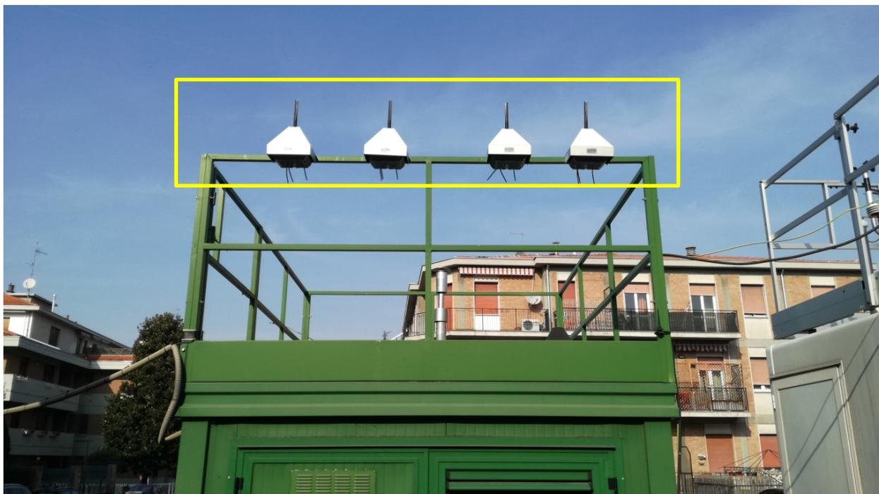
**Figura 1:** Esempio di collocazione degli AQMESH presso una centralina di monitoraggio della qualità dell'aria (Stazione da traffico di Via Montebello a Parma)
