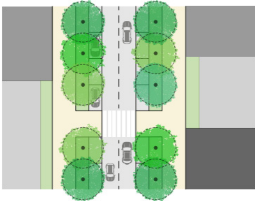
STRADA A DOPPIO SENSO DI MARCIA CON CORSIA SINGOLA E PARCHEGGI IN LINEA
