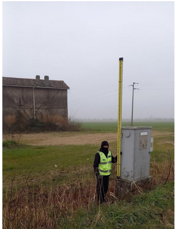
Figura 1 - Alcune fasi delle misure di livellazione geometrica di alta precisione.
