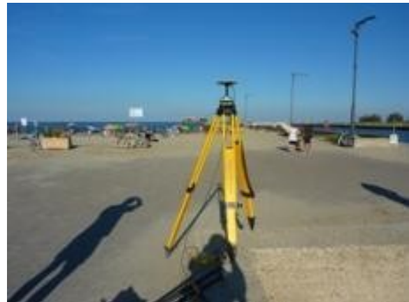
Figura 5 - Caposaldo/Vertice PGFV0100: fasi di livellazione e misure GNSS. Caposaldo fondamentale della RGC2023.
