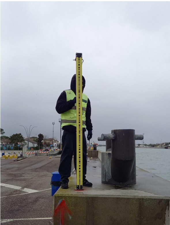
Figura 1 - Alcune fasi delle misure di livellazione geometrica di alta precisione.
