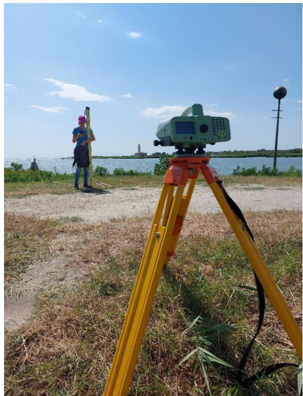
Figura 6 - Caposaldo/Vertice PGFV0500: fasi di livellazione e misure GNSS.
