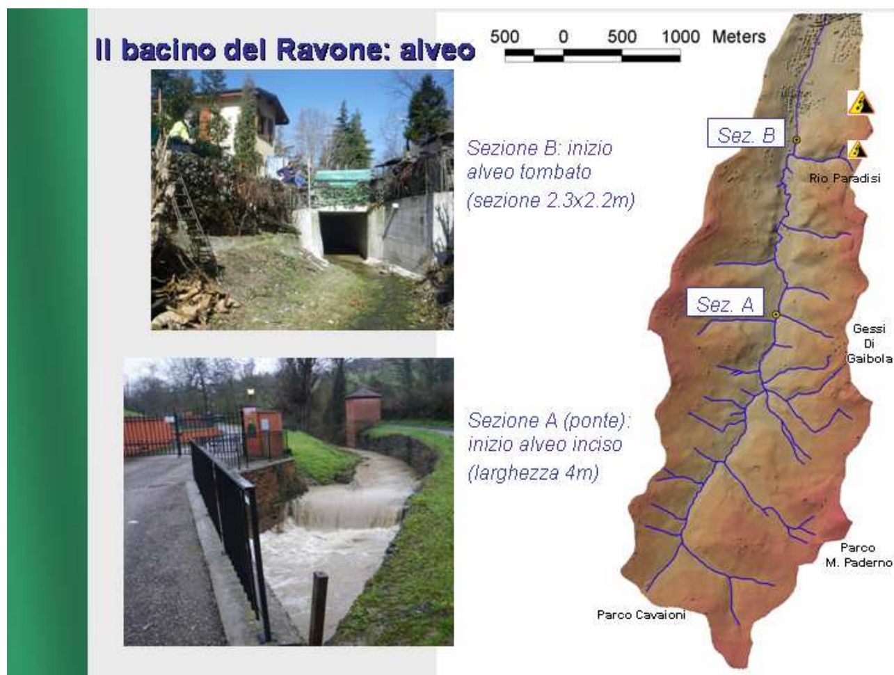
Figura 6: Schema riportante l'orografia e il reticolo idrografico del bacino. Le due foto mostrano due sezioni del bacino, in corrispondenza della tombatura e in corrispondenza dell'alveo inciso.
