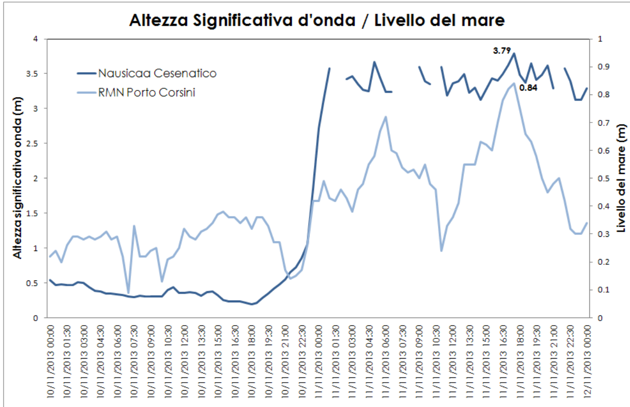
Figura 38: Altezza significativa dell'onda registrata dalla boa dell'Emilia-Romagna Nausicaa installata al largo di Cesenatico e livello del mare registrato dal mareografo della Rete Mareografica Nazionale gestito da ISPRA ed installato a Porto Corsini (Ravenna). Entrambi gli strumenti hanno registrato il massimo delle rispettive grandezze alle ore 17:30 UTC dell'11 novembre 2013.
