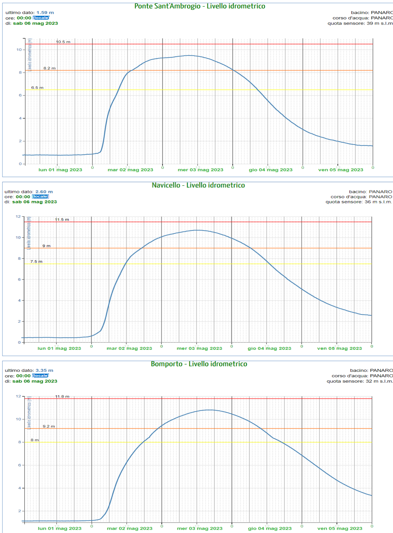
Figura 22: Idrogrammi di piena nelle sezioni idrometriche più significative del tratto arginato del fiume Panaro (dati non validati).
