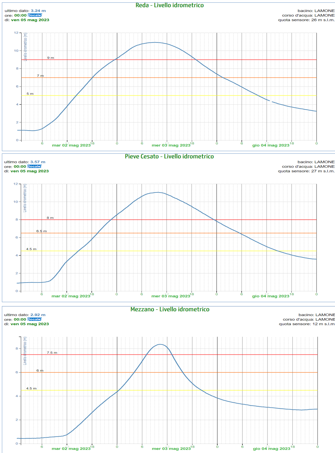
Figura 36: Idrogrammi di piena nelle sezioni idrometriche più significative del tratto arginato del fiume Lamone (dati non validati).
