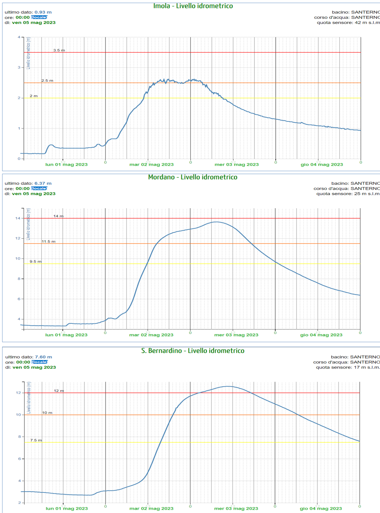
Figura 31: Idrogrammi di piena nelle sezioni idrometriche più significative del torrente Santerno (dati non validati).
