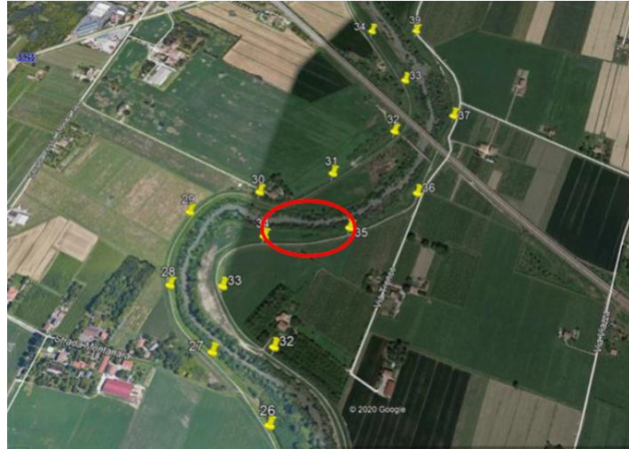
Figura 35: Ortofoto con ubicazione della rotta dell'argine destro sul fiume Panaro.
